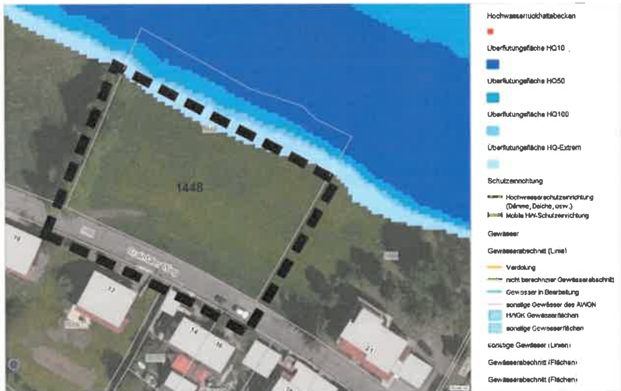
Abb. 5: Aktuelle Hochwassergefahrenkarte der Landesanstalt für Umwelt Baden-Württemberg bzw. Hochwasserrisikomanagement-Abfrage der Landesanstalt für Umwelt Baden-Württemberg (Ausschnitt o. M.)
